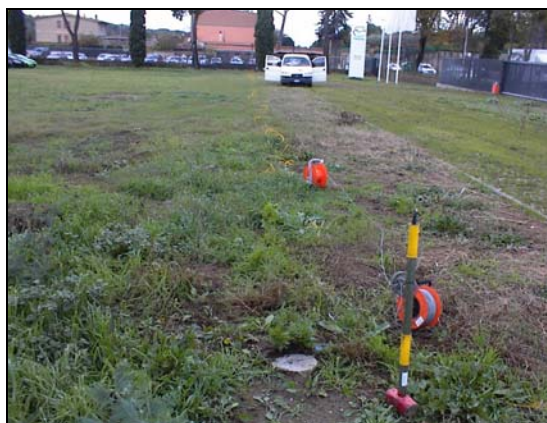
PARTICOLARE STENDIMENTO SISMICO
