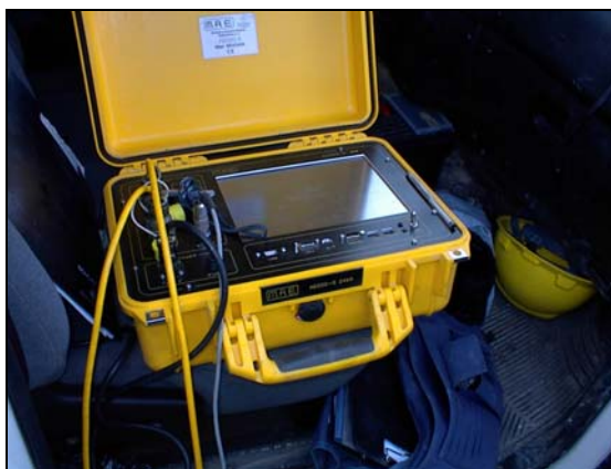
CENTRALINA DI ACQUISIZIONE MAE MODELLO A6000S
