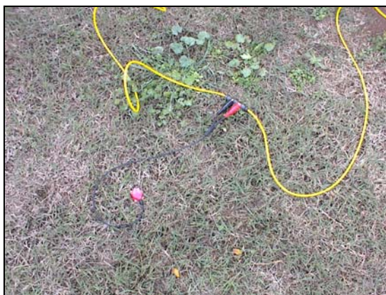
PARTICOLARE GEOFONO DI ACQUISIZIONE ONDA SISMICA
